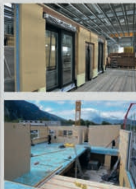
Linia produkcyjna elementów ściennych w fabryce Osterhofen
