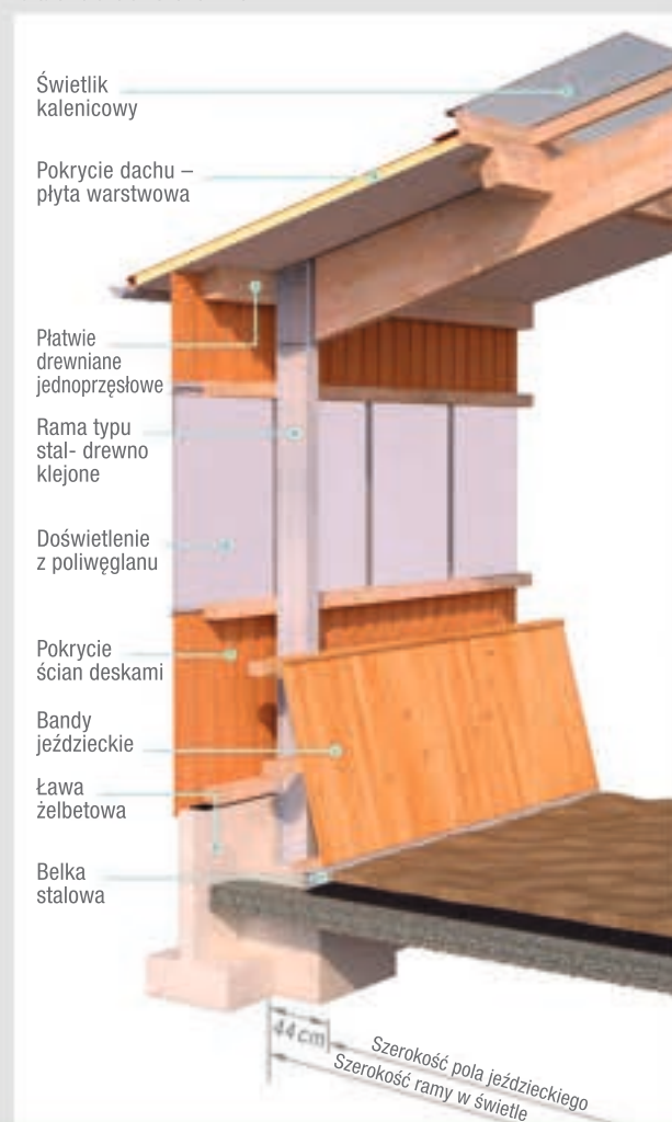
Rama typu stal- drewno klejone ze ściągami, dach krokwiowy z pokryciem dachówką, świetlik w kalenicy, ściany wykonane z prefabrykowanych elementów betonowych malowanych na biało lub obite drewnem
